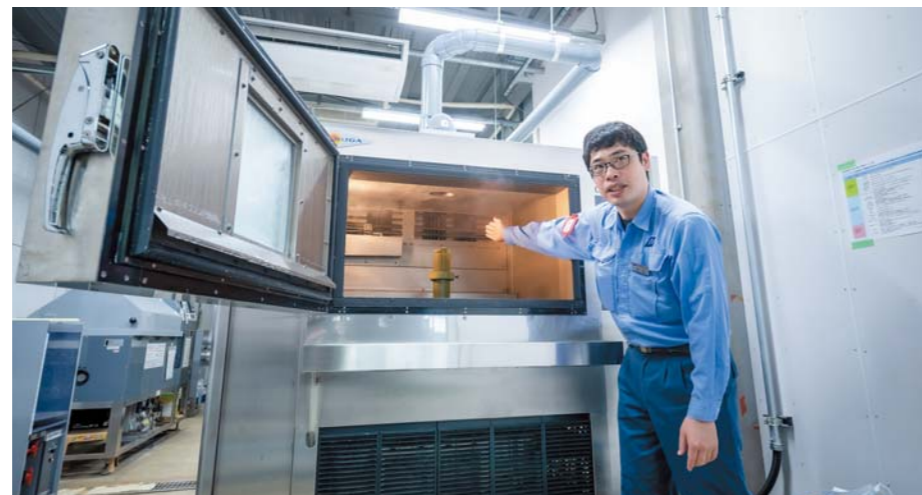
日本パーライジングが使用する「促進腐食試験機」。この試験機で各国の腐食評価条件を比較評価した
