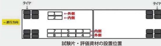
試験片・評価資材の設置位置
