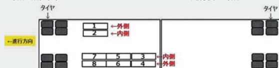
試験片・評価資材の設置位置
