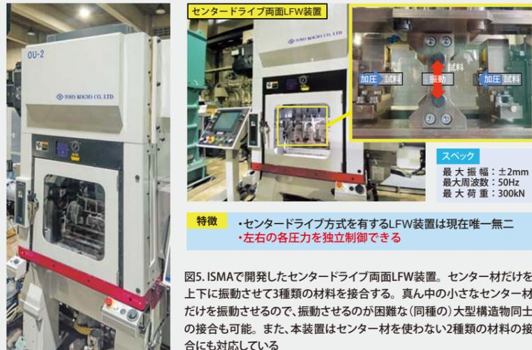
図5. ISMAで開発したセンタードライブ両面LFW装置。センター材だけを上下に振動させて3種類の材料を接合する。真ん中の小さなセンター材だけを振動させるので、振動させるのが困難な(同種の)大型構造物同士の接合も可能。また、本装置はセンター材を使わない2種類の材料の接合にも対応している
