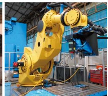
図10. 日立グループが開発した「ロボットFSW装置」。さまざまな形状の超ハイテン接合部材に対応可能
