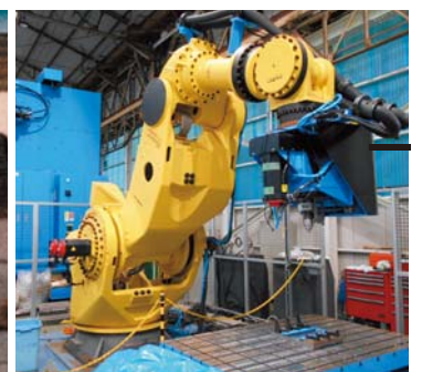
図10. 日立グループが開発した「ロボットFSW装置」。さまざまな形状の超ハイテン接合部材に対応可能
