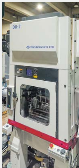
図5. ISMAで開発したセンタードライブ両面LFW装置。センター材だけを上下に振動させて3種類の材料を接合する。真ん中の小さなセンター材だけを振動させるので、振動させるのが困難な(同種の)大型構造物同士の接合も可能。また、本装置はセンター材を使わない2種類の材料の接合にも対応している
