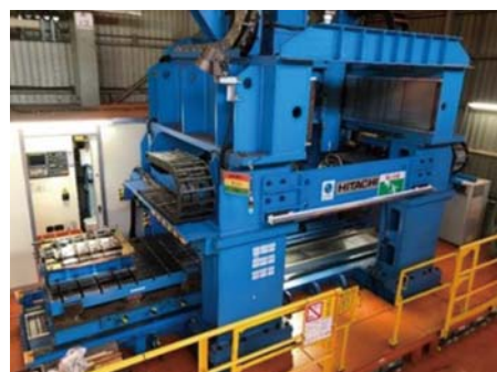
図8. JFEスチールが開発した「ハイブリッドFSW」に対応した実験装置。超ハイテン材をレーザー溶接並みの高速で接合可能
