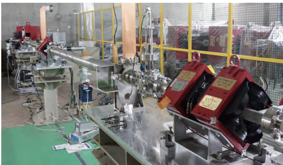
産業技術総合研究所で開発中の小型加速器中性子施設の電子加速器ビームライン（2019年度運用開始）
