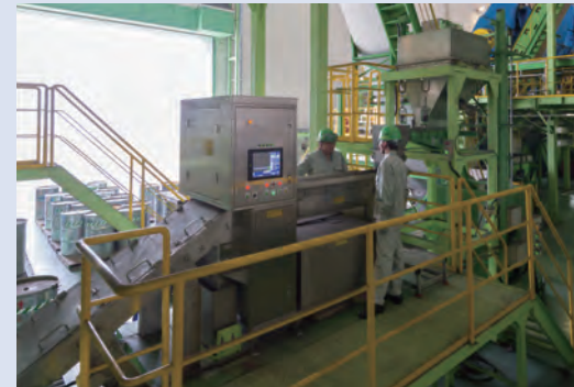
高Feスポンジチタン自動選別機 Automatic high-Fe titanium sponge sorting machine
