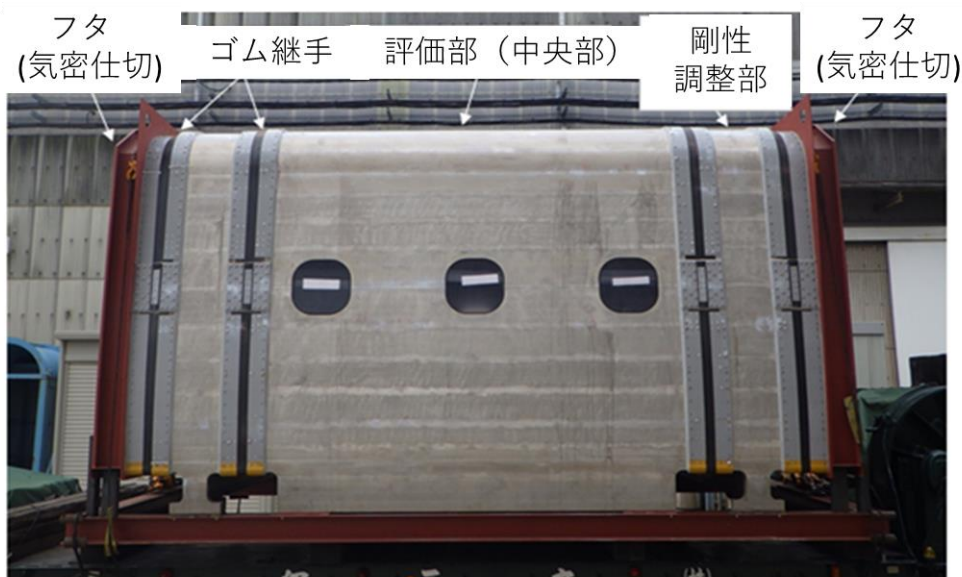
図1 客室一般部を模擬した高速鉄道車両の部分構体（長さ5m）の外観
