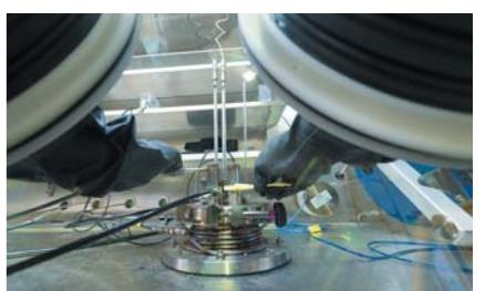
小型チタンの電析試験設備(茅ヶ崎分室)。チタンは酸化しやすいため、不活性ガスが充填されたドラフト内(グローブボックス)で作業する
