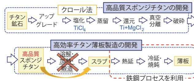
図1 従来の製造プロセスから中間工程を省略した「非溶解プロセス」
