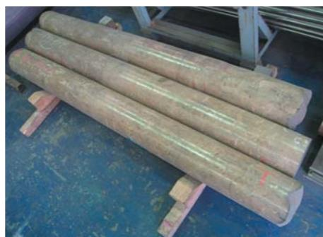
試作品(ビレット鍛造工程完了時)
