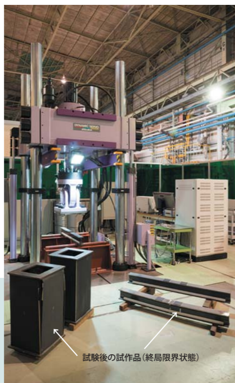
載荷試験装置 (奥)。試作品：複合柱構造部材 (手前左)、複合I桁構造部材 (手前右) (横浜磯子分室)
