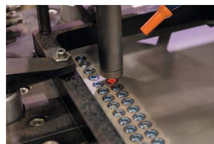
FSJロボットで鋼板を接合中
