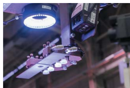
接合部を撮影し、接合状態を確認
