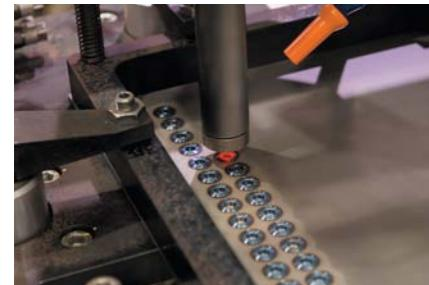
FSJロボットで鋼板を接合中
