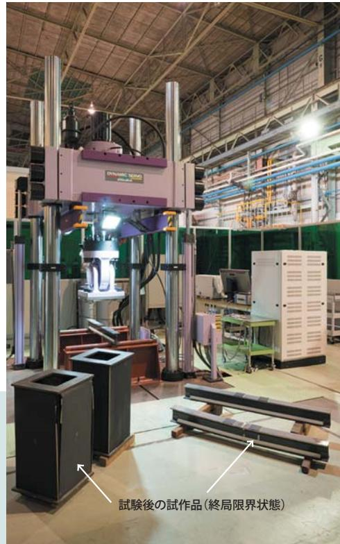
載荷試験装置(奥)。試作品：複合柱構造部材(手前左)、複合I桁構造部材(手前右)(横浜磯子分室)
