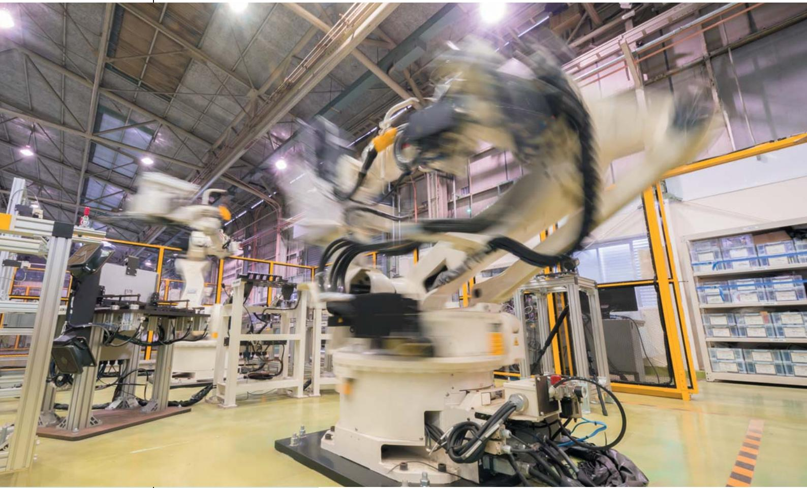
接合温度制御ソフトを搭載したツール耐久性自動評価システム。接合専用の鋼板用FSJロボット(手前)と試験片を準備する材料ハンドリング専用ロボット(奥)が連動して、餅つき(餅をつく人と返す人)の要領で動く(明石分室)
