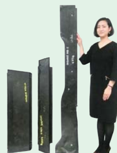
左からセンターメンバー、リアパネル、サイドシルの試作品 (写真提供：名古屋大学集中研分室)
