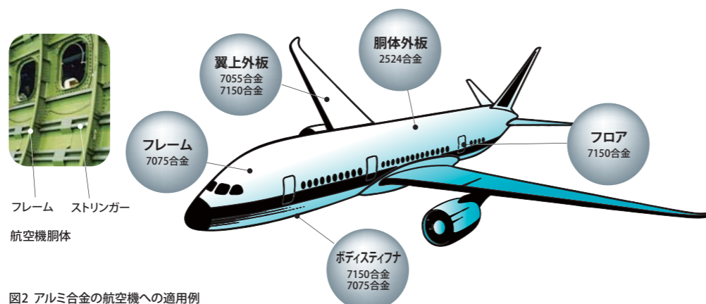
図2 アルミ合金の航空機への適用例
