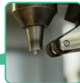
FSW装置。先端のピンを回転させながら接合材に押し込み、摩擦熱を利用して接合
