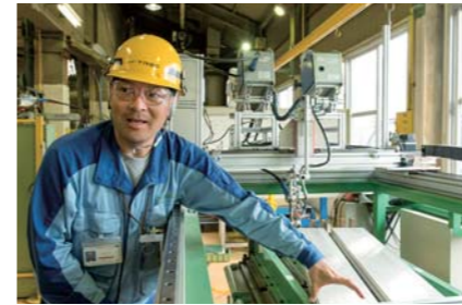
Mg合金の接合に使用したMIG溶接機について説明する石川氏
