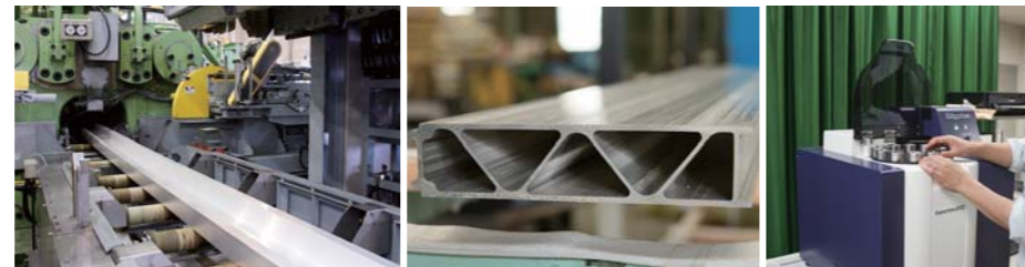
6000t押し出し機(右写真のダブルスキン材が押し出される)
