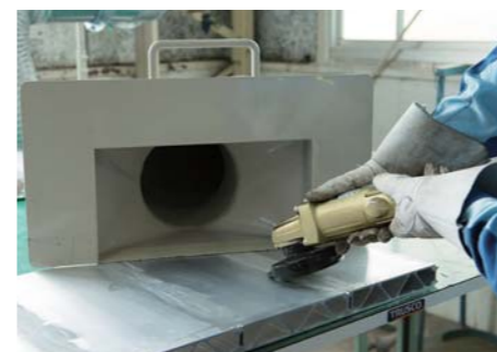
Mg合金の粉塵は燃えやすいので、集塵機を使用して安全を確保
