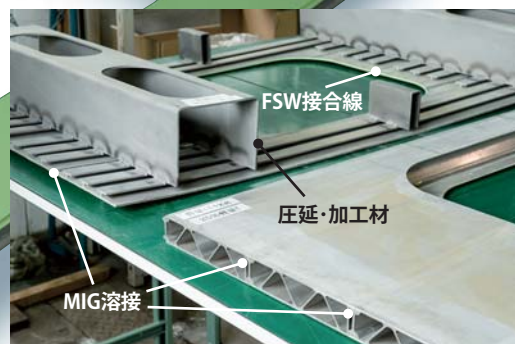
側パネルの裏面。奥のシングルスキン形材は強度を上げるために圧延・加工材が必要。両パネルとも重量は14kg。同様のAl材より25%の軽量化を達成。
