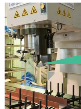
FSW装置。先端のピンを回転させながら接合材に押し込み、摩擦熱を利用して接合
