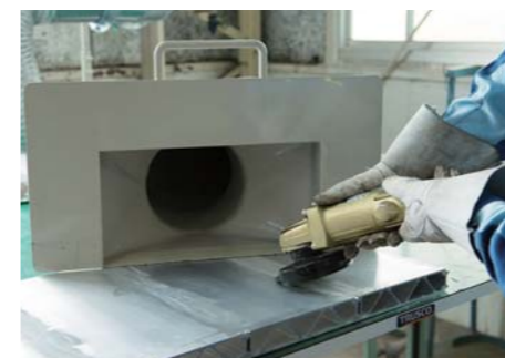
Mg合金の粉塵は燃やしやすいので、集塵機を使用して安全を確認
