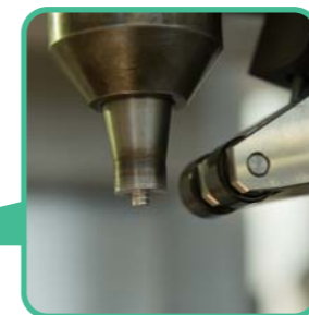
FSW装置。先端のピンを回転させながら接合材に押し込み、摩擦熱を利用して接合
