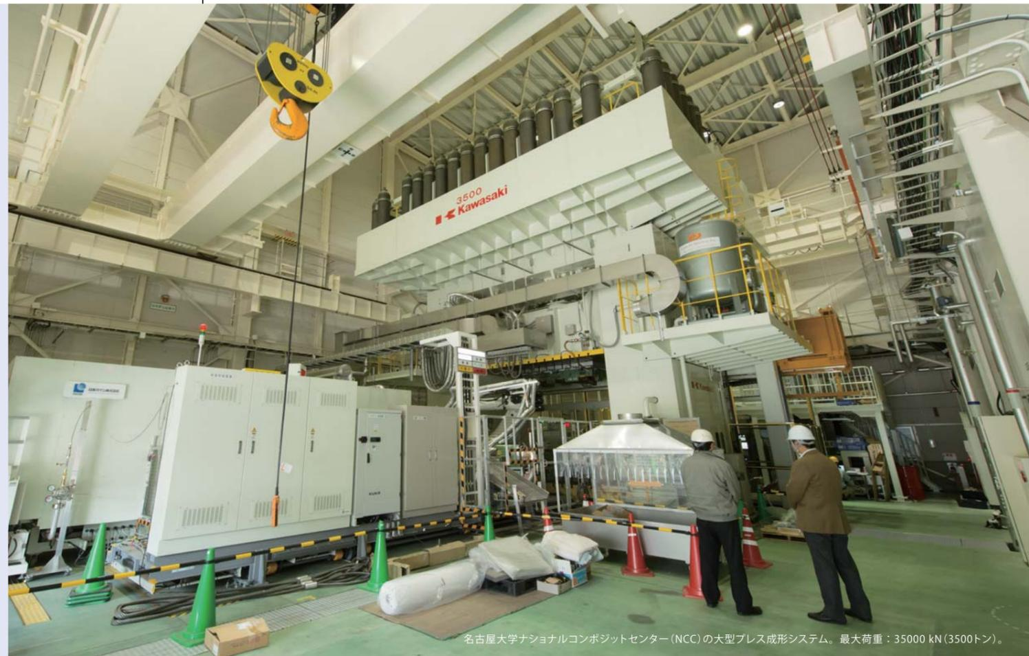
名古屋大学ナショナルコンポジットセンター(NCC)の大型プレス成形システム。最大荷重：35000 kN (3500トン)。
