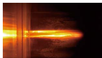
装置内でのマイクロ波照射による繊維加熱の様子
