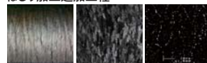
図4-2 通常工程材とねじり加工追加材のピレット表面金属組織
