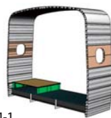
図4-1 簡易モックアップ構体模型図 (3380mm幅×2650mm高×1040mm長)
