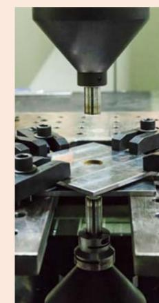
フラットFSW装置のネジ加工のないプロープ。上下のツールで接合
