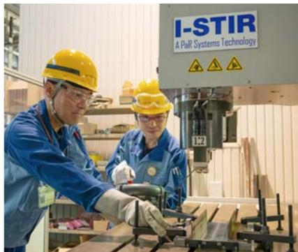
摩擦攪拌接合(FSW)作業
