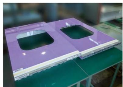
図1 開発合金を使用して試作した側パネル。左がシングルスキン形材、右がダブルスキン形材(トラス断面)
