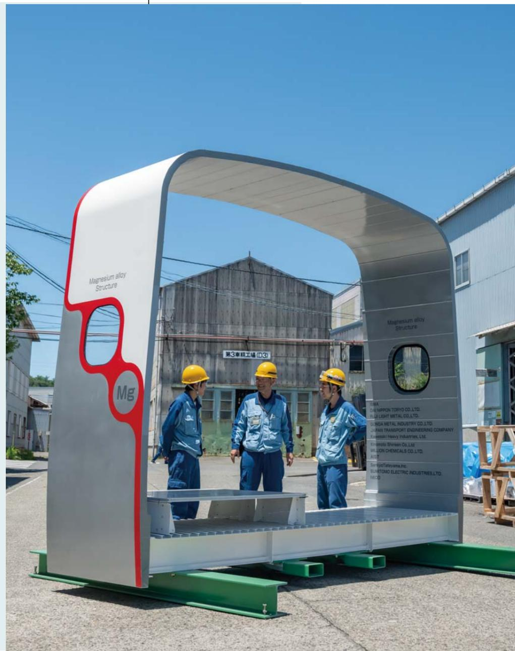
試作した難燃性Mg合金製高速鉄道車両部分構体。幅: 3380mm、高さ: 2880mm、長さ: 1040mm、質量: 239kg。(総合車両製作所にて撮影)
