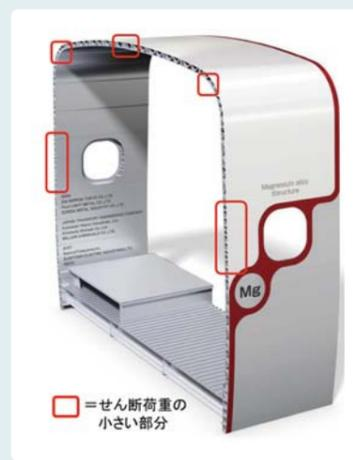
図6 ハモニカ断面を採用した部分
