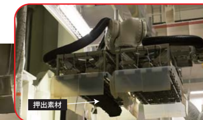
(写真上) マテハン1が保温装置を通った押出素材を掴み、プレス機にチャージする。
