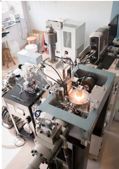
図9 横堀式高温クリープ試験機(島津製作所、1981年)。試験片切欠き近傍に生じるクリープや疲労損傷を試験中、画面で確認しながら連続測定し、損傷域などが解析できる世界初、かつ唯一の方式の装置で、現在まで改良が進められている(帝京大学)。
