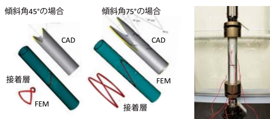
図4 傾斜角を持つ接着パイプ試験片
