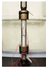
図5 引張試験(傾斜角0°のパイプ試験片)
