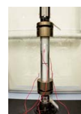
図5 引張試験(傾斜角0°のパイプ試験片)
