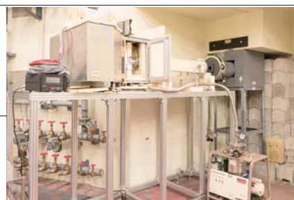
図1 HUNS-IIに増強されたナノ組織解析装置(北海道大学)
