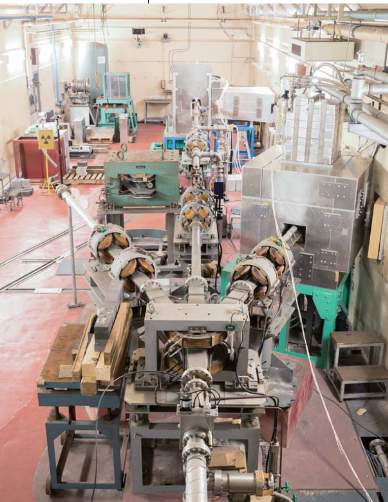
HUNS-1 (小型中性子源)の主要装置。左がターゲット、右が加速器(北海道大学)
