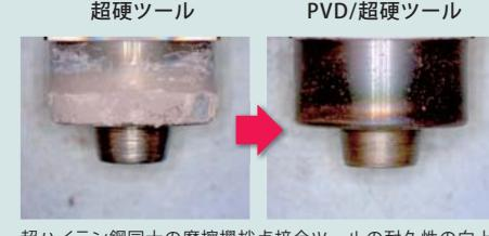
超ハイテン鋼同士の摩擦攪拌点接合ツールの耐久性の向上(一定期間試験後)
