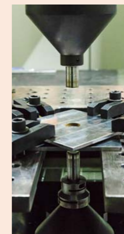
フラットFSW装置のネジ加工のないプロブ。上下のツールで接合
