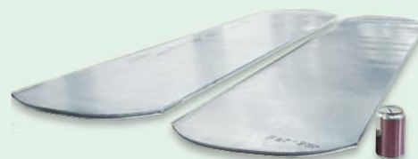
幅450mmの圧延板材(引張強度:735MPa、耐力:687MPa、伸び:10%)と缶の大きさの比較 (写真提供: 千年分室)
