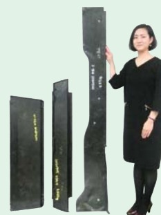
左からセンターメンバー、リアパネル、サイドシルの試作品 (写真提供: 名古屋大学集中研分室)
